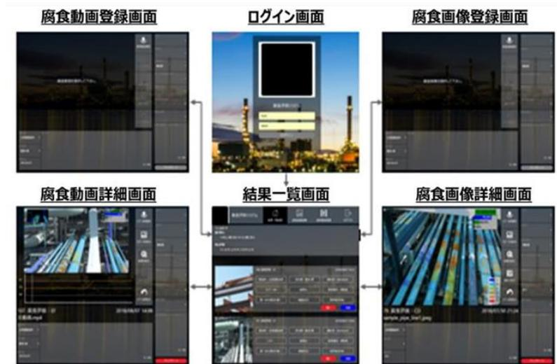
図6 腐食評価システムの画面イメージ
