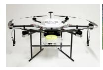
イームズロボティクス/エアロスプレイヤーAS5  $(W1060 \times H300 mm, 15.9 kg)$
