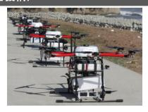
自律制御システム研究所/ACSL-PF1 (W1173×H483mm、6.2kg)
