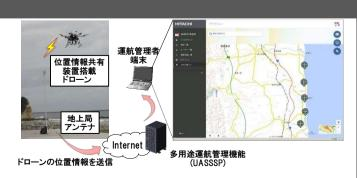
位置情報共有装置連携による多用途運航管理機能の飛行状況監視イメージ
