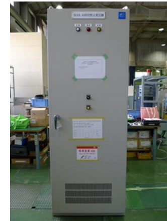
AVRユニットミニモデル (容量3kVA、200V)
