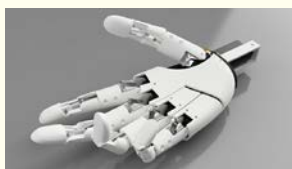
研究開発した人間型 5 指 のロボットハンド「F-hand」
