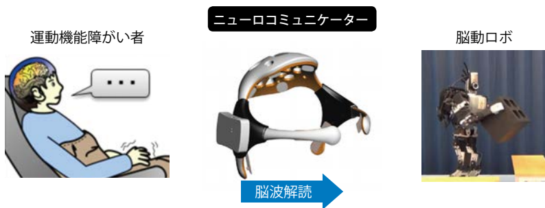
脳波によるロボットアバター制御システムの概要
