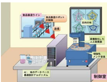
食品製造ラインにおける 自動化味覚センサの実装
