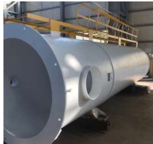
耐圧設計が47MPaの5m 3 水素タンク
