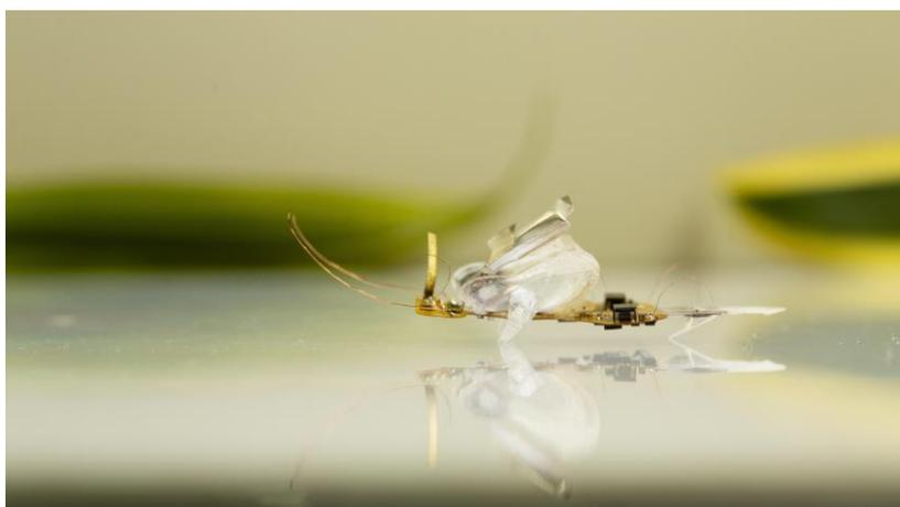
人工筋肉は、2本のソフト電極に挟まれたエラストマー膜から成る。電圧が加わるとこれらの電極が引き寄せあってエラストマー膜を圧縮し、電圧を切ると元の形状に戻る。このロボティックインセクトは、3本の脚それぞれに、そのような人工筋肉を装着している。動作は、毎秒400回を超える電圧の、非常に迅速なオンオフ切り替えにより生じている。
