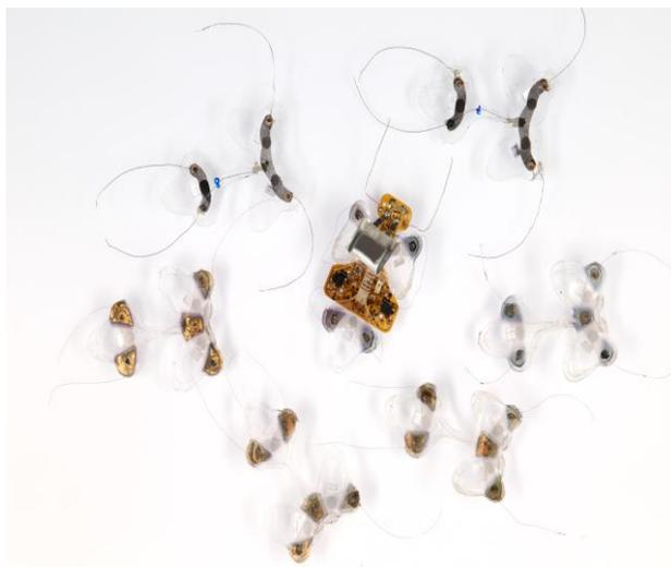
研究チームは、ナノファブリケーション技術を用いてエラストマー膜の厚さを薄くし、わずか数分子厚の極微小な高導電性ソフト電極を製造することで、人工筋肉の比較的低電圧での作動を実現した。このような優れた設計により、電源のサイズは大幅に縮小された。
