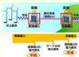
高圧直流送電用変換器の効果
