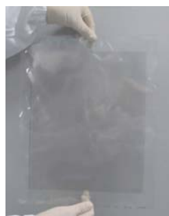
指示基板を持たないフリーフィルム基板
