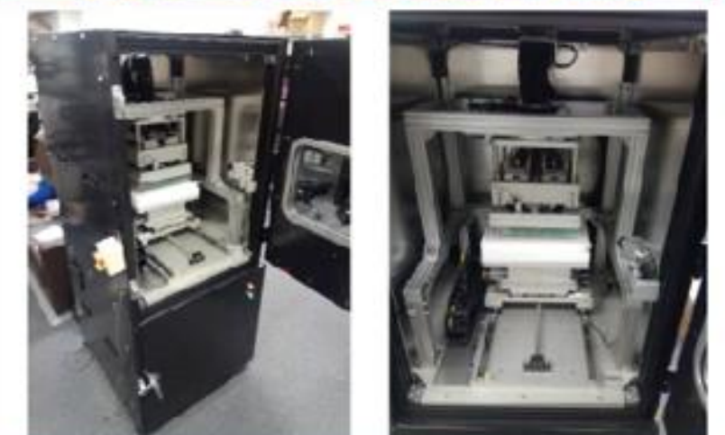
性能:500ch磁界センサアレイ 磁界検出能:1pT / √Hz(10 kHz時) 撮像エリア:24cm×24cm
