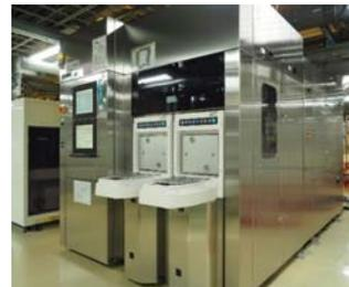
300mm ウェハの裏面を研削、研磨。工程中に発生するパーティクルや汚染が加工中のウェハ表裏面に付着しないように高洗浄度での洗浄を保有する装置
