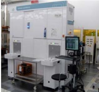
300mm ウェハ上のシリコン貫通工程において、深穴側壁への均一な膜、特に、シリコン酸化膜、シリコン窒化膜、シリコン酸窒化膜に加えてアモルファスシリコン膜の成膜を可能な装置
