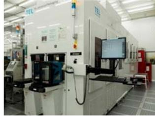
300mm ウェハ上のIoTデバイス試作に不可欠なシリコン貫通工程において、深穴中にめっきにより均一に、銅、ニッケル、錫-銀電解めっきが可能で、自動的薬液補充可能な装置
