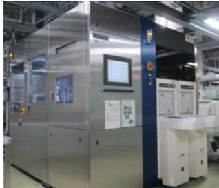
積層用ウェハの薄化時のウェハ割れ防止対策として必要なウェハのエッジをトリミング加工する装置
