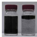
水中攪拌30秒後 左: CSCNT、右: 他社MWCNT (分散剤未使用)
