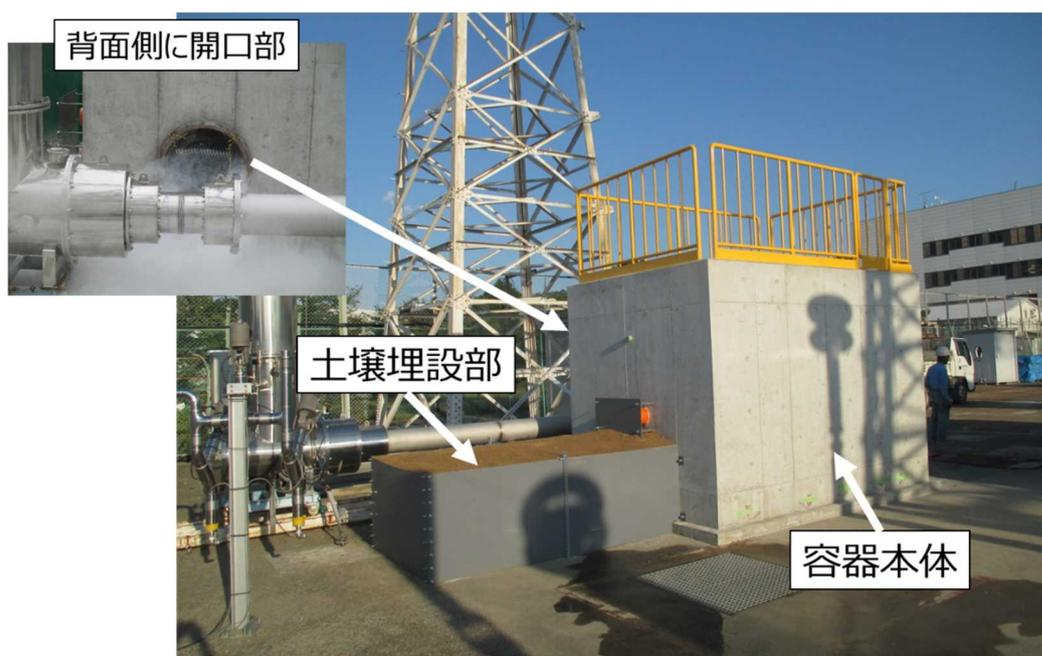
図 2.1.1.3. (1)-8 漏洩本試験の試験装置外観
