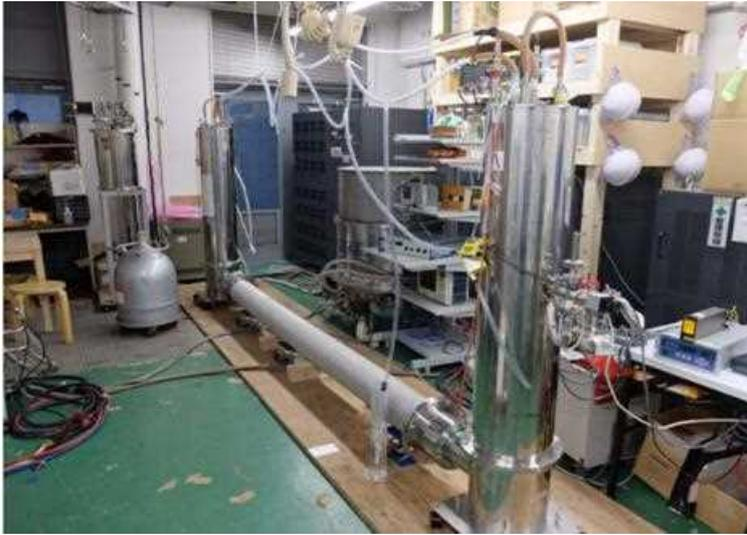
図 2.1.3.1-2 短尺断熱管試験装置
