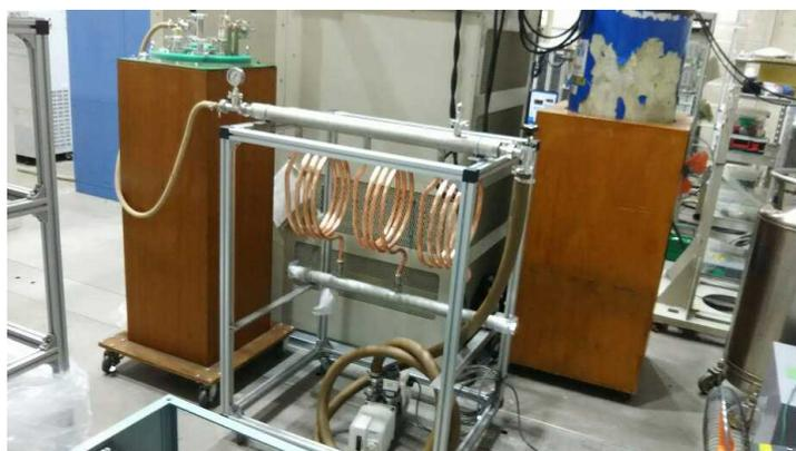
図 2.4.3.5-23 温度可変交流損失測定システムの排気熱交換器
