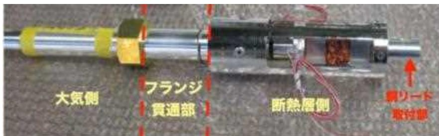
4 図 2.2.2.3- 13 試作した PCL の外観写真
