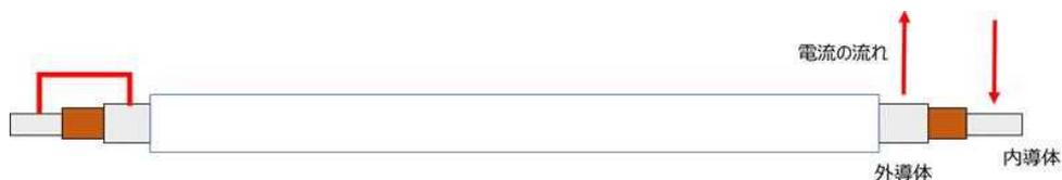
図 2.2.1.4-2 過電流試験用短尺サンプル
