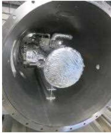
図 2.2.2.3- 9 端末クライオスタット外槽に内槽を組み込んだ状況
