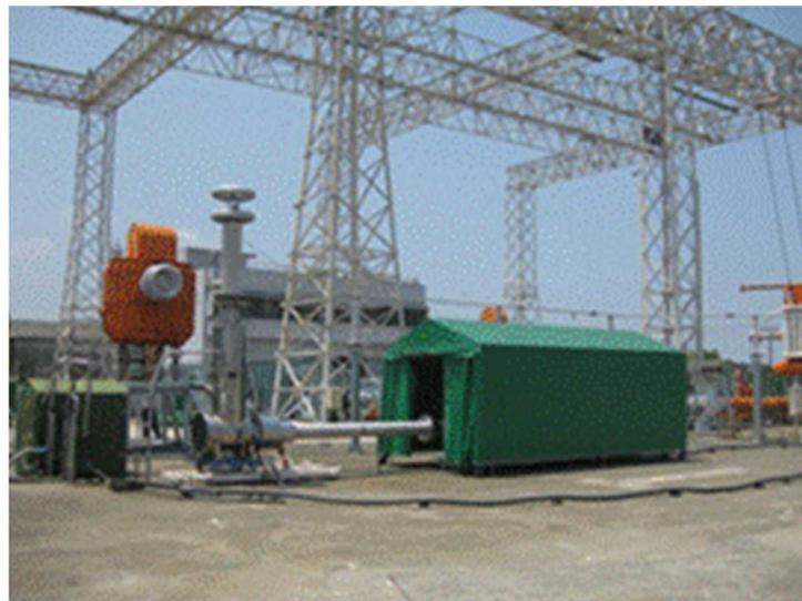
図 2. 2. 1. 4- 4 石狩向け超電導コアサンプル、ジョイントの課電試験の様子
