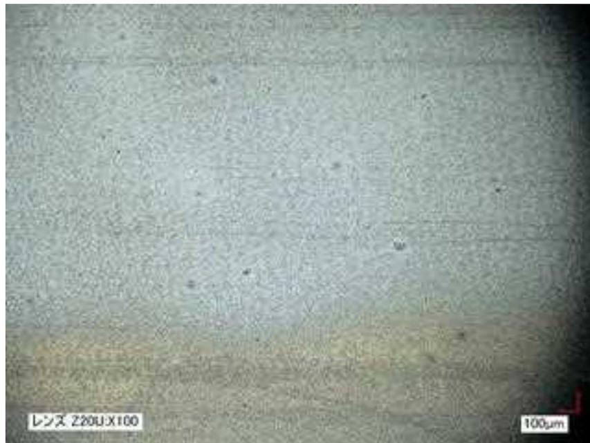
図 2.3.3.1-5 スプレーコート条件適正化で塗布均一となったサンプルの表面状態
