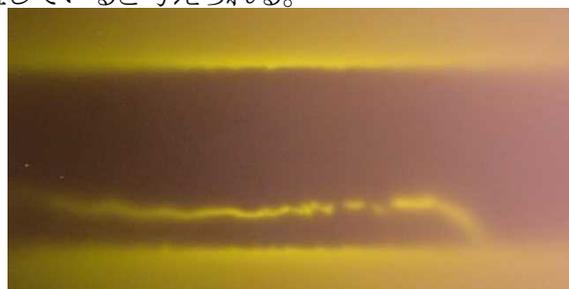
図 2.4.2.1-10 超電導層の剥離による劣化 (20 K, 約 24 mT)
