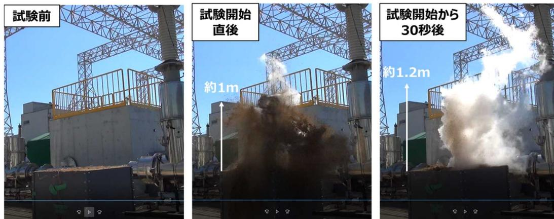
図 2. 1. 1. 3. (2)-3 管路模擬漏洩試験の様子
