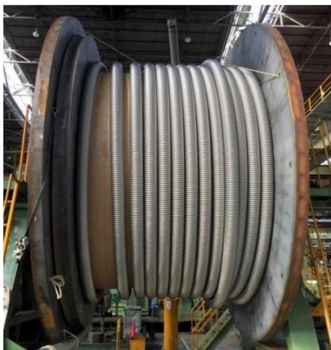
図 2.1.3.2-7 製作した 275 kV 級 100 m 級断熱管
