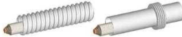
図 2.2.2.3- 2 コルゲート管（左）と直管（右）の内管の模式図
