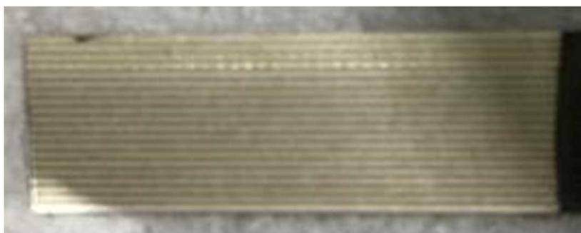
図 2.4.3.4-10 レーザスクライブ法で 16 分割に細線化した 10 mm 幅 EuBCO + BHO 線材
