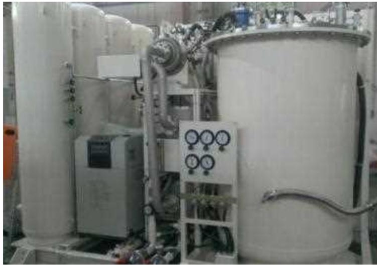
図 2.2.2.3- 32 ターボブレイトン冷凍機
