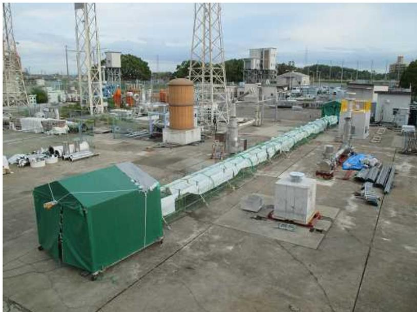
図 2. 1. 3. 1-6 長尺断熱管の試験状況
