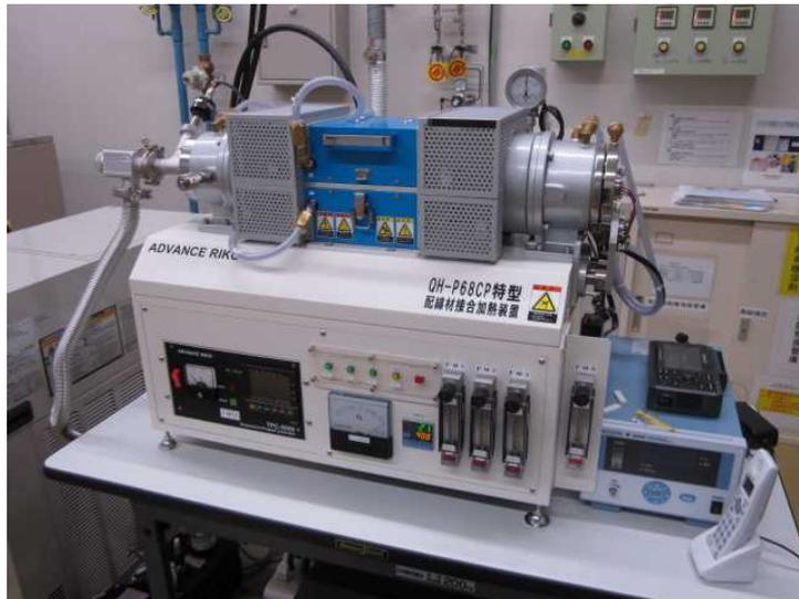
図 2.3.3.1-9 新規導入した本焼用小型焼成炉
