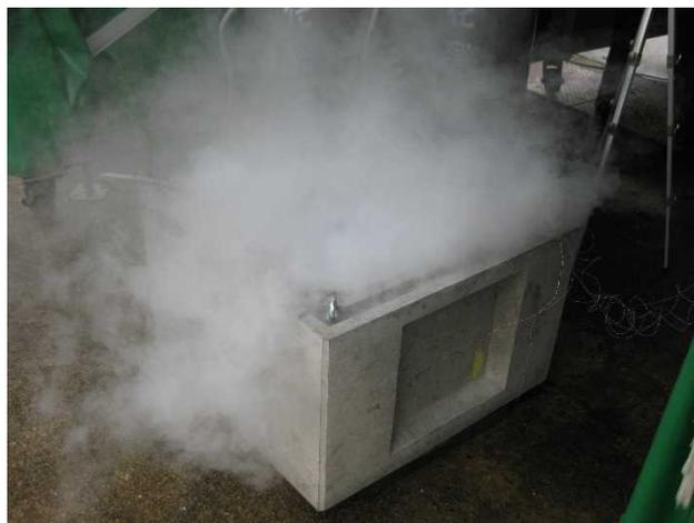
図 2. 1. 1. 3. (1)1-1 コンクリート製小容器の冷却試験
