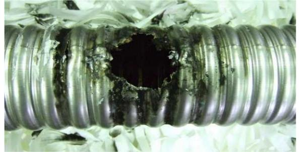
(a) MLI 除去後、地絡保護層を残した状態 (b) コルゲート管がむき出しになった状態
