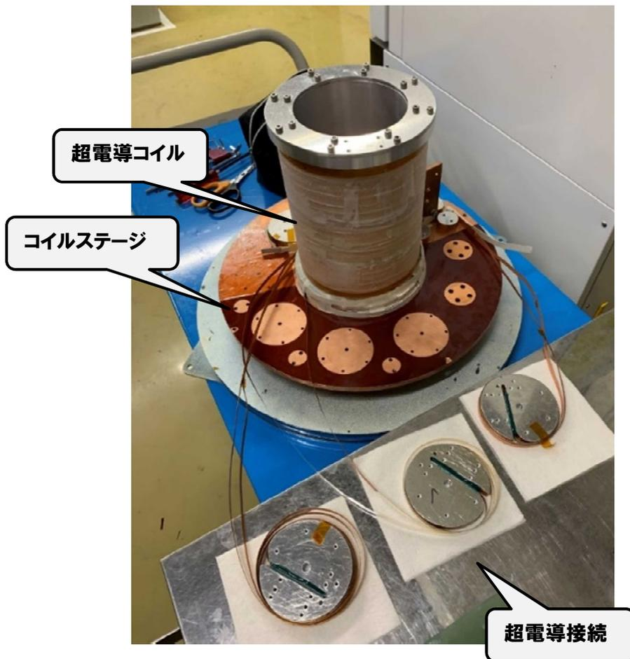
図 2.3.3.4-2 永久電流試験用小型コイルのコイル接続
