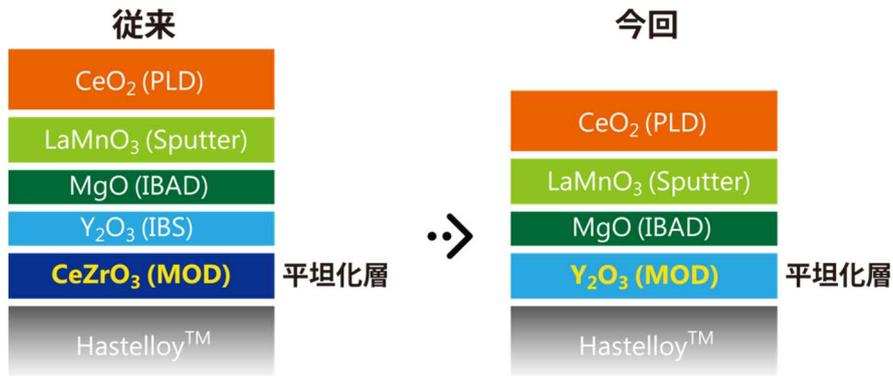
図 2.4.3.2-2 MOD 平坦化プロセスを用いた中間層付きハステロイ™基板の構造
