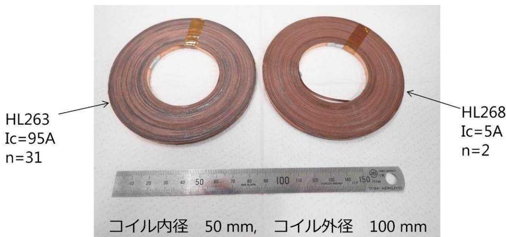
図 2.4.2.2-30 非破壊特性分布測定試験に用いたエポキシ樹脂含浸測定サンプル
