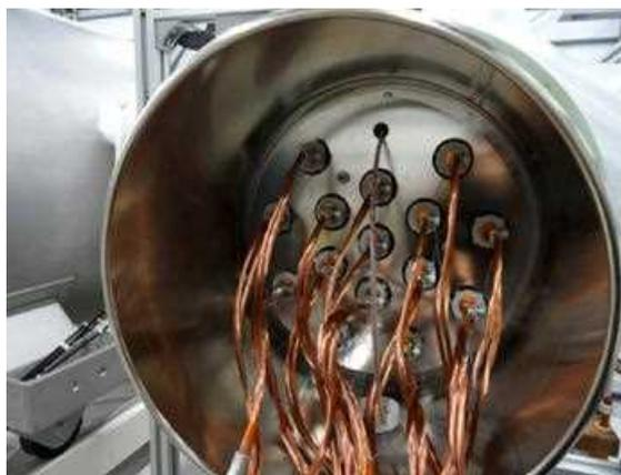
図 2.2.1.6-12 PCL フランジ解体後の銅リード部の外観写真 (端末 A)
