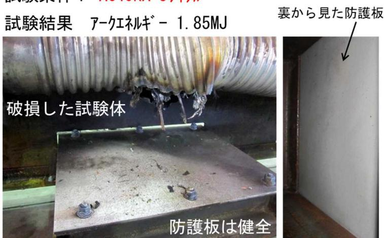
図2.1.1.2.(2)-7 防護対策していない試験体を用いた防護板の効果確認試験結果
