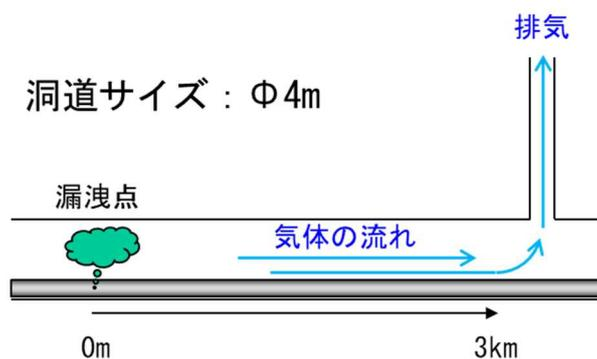
図 2.1.1.3.(3)-1 洞道内での液体窒素漏えい検討モデル
