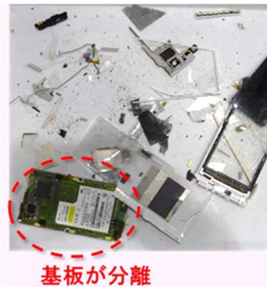
図 3.1.2.4 筐体破壊試験結果の例
