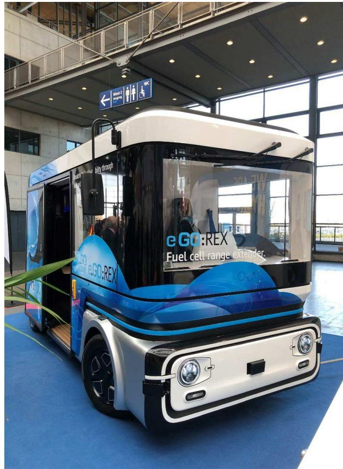
※Proton Motor製30kWスタック搭載
