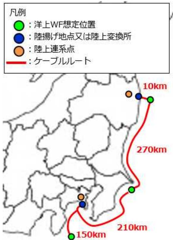
図3-1 洋上系統の概念図
