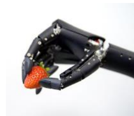
単純制御でさまざまな物をつかむロボットハンドの「からくり」
