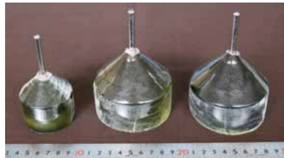
④: VB法で育成したφ2-3インチ \beta -Ga 2 O 3 単結晶
