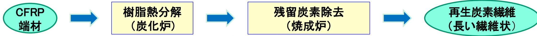
CFRPリサイクル技術(2段階熱処理法)
