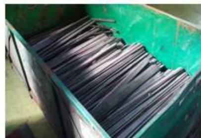
航空機補強材端材
