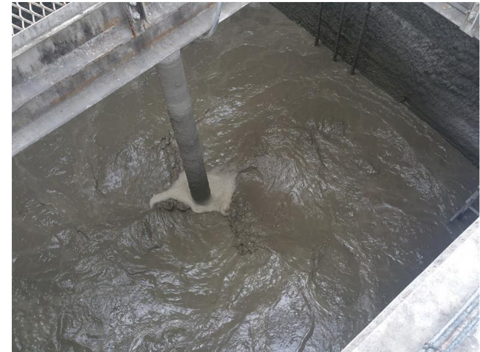
〔生コンスラッジ水〕
