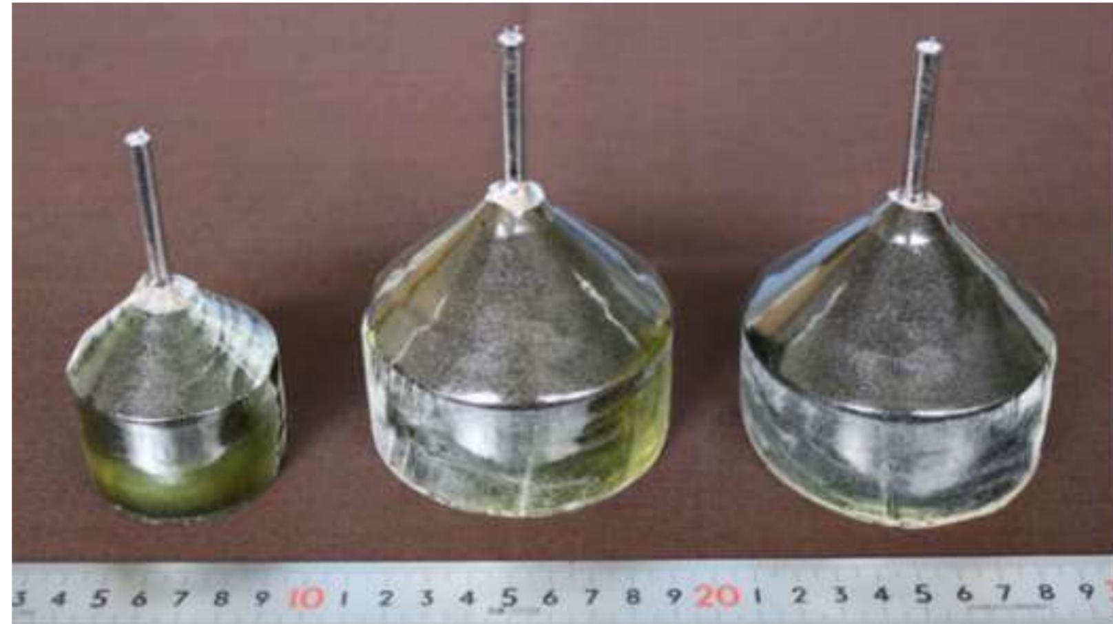
φ2 inch 単結晶    φ3 inch 単結晶(1回目)    φ3 inch 単結晶(2回目)
