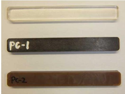
図Ⅲ-2.2.1.1- 65 変性リグノ CNF/PC の射出成形品の外観
