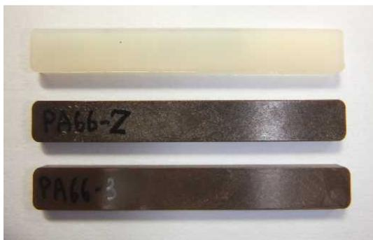
図Ⅲ -2.2.1.1- 71 変性リグノ CNF/PA66 の射出成形品の外観
