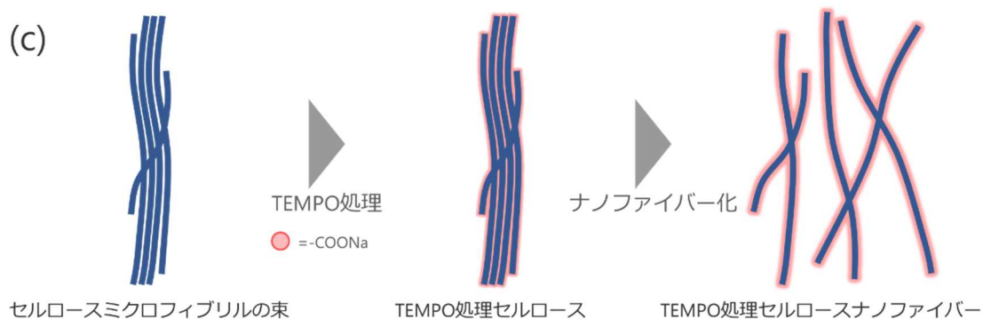
図III-2.2.1.3.2.3-14 (a) TEMPOの構造、(b) TEMPO処理によるセルロースマイクロフィブリルの変性、(c) TEMPO処理セルロースのナノファイバー化
