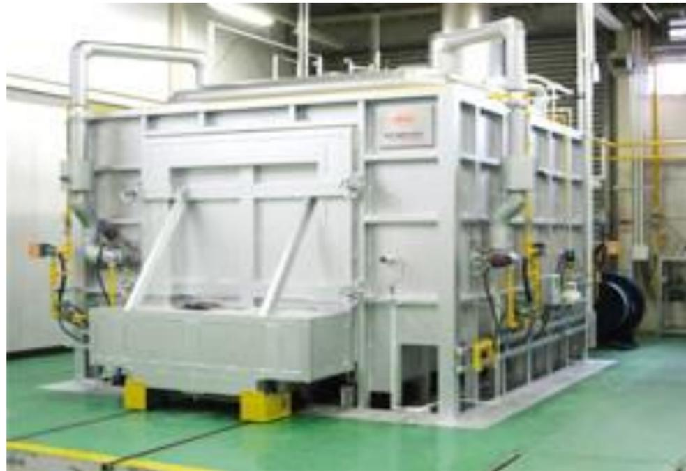
バッチ式高温用ガス焼成炉
