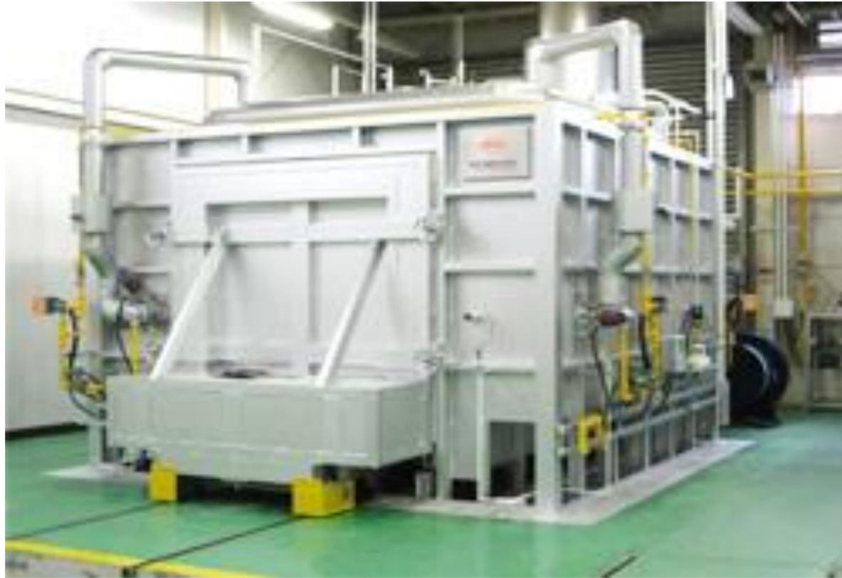
バッチ式高温用ガス焼成炉
