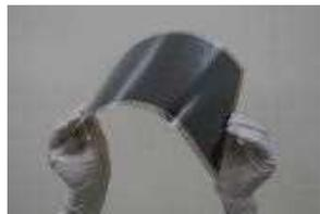
東芝: **世界最大面積のフィルム型**ペロブスカイト太陽電池モジュール (24.15cm × 29.10cm、面積703cm<sup>2</sup>)
