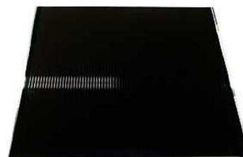
世界最高変換効率19.2%を達成したCIS系薄膜太陽電池サブモジュール(30cm角)
