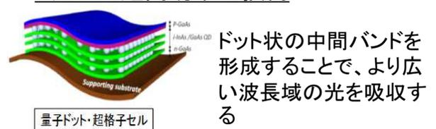
開発成果 III-V族化合物太陽電池(研究開発項目②:革新的高効率太陽電池)
