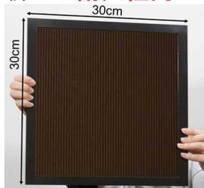
パナソニック: インクジェットを用いた大面積塗布法を開発し、太陽電池モジュール(802cm<sup>2</sup>)で**世界最高のエネルギー変換効率16.09%**を達成。(その後17.93%)
