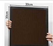
図1 世界最高水準となる変換効率16.09%を達成したペロブスカイト太陽電池モジュール
