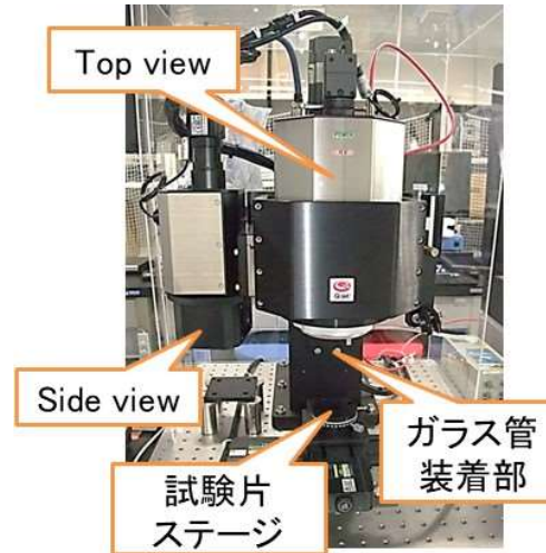
図2 マイクロ電気化学システムと微小電極作製技術の開発
