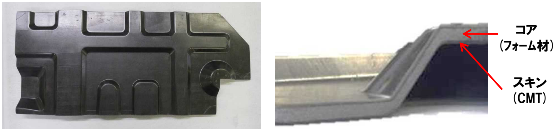
図III-2.6.2-18 CMTを用いたサンドイッチ成形体
