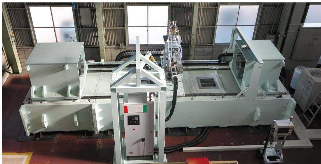
図Ⅲ-2.2.1-7 φ95mm ねじり鍛錬加工装置の外観
