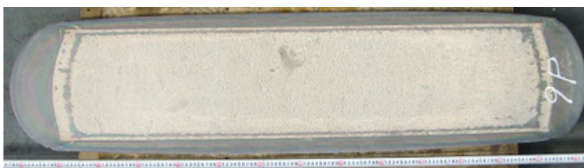
図Ⅲ-2.4.2-4 大型チタン梱包体から製作したチタン厚板
