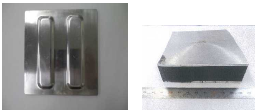
図III-2.6.2-17 アルミ/CFRTP一体成形品
