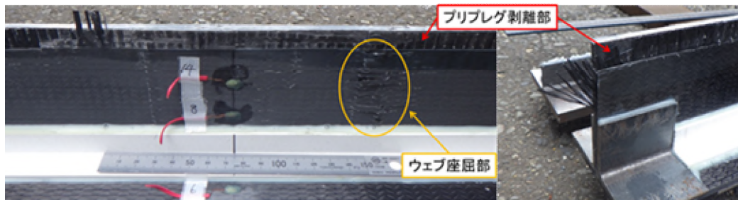
図Ⅲ-2.7.7-5 試験後の構造破壊状況
