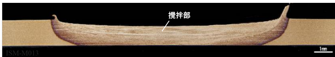
図Ⅲ-2.7.12-14 接合部断面写真
