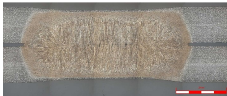
図Ⅲ-2.7.13-88 従来溶接機による抵抗スポット溶接部断面
