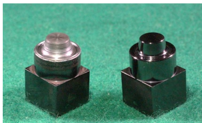
図Ⅲ-2.7.6-7 ツール写真（左：1万打点後、右：新品）
