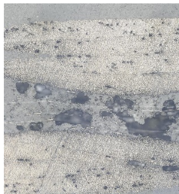
図Ⅲ-2.8.12-11 含浸が不完全な CFRP 平板断面の顕微鏡写真
