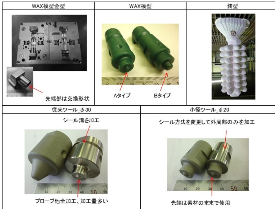
図Ⅲ-2.7.12-25 精密鋳造品の製造工程及びツール形状比較
