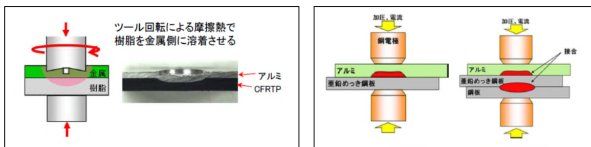
図Ⅲ-2.7.5-1 アルミニウム/CFRP の点接合 図Ⅲ-2.7.5-2 アルミニウム/鋼板の点接合
