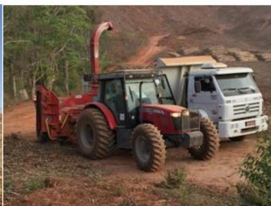
図 2-1-6-1-3 木材破砕機および輸送トラック
