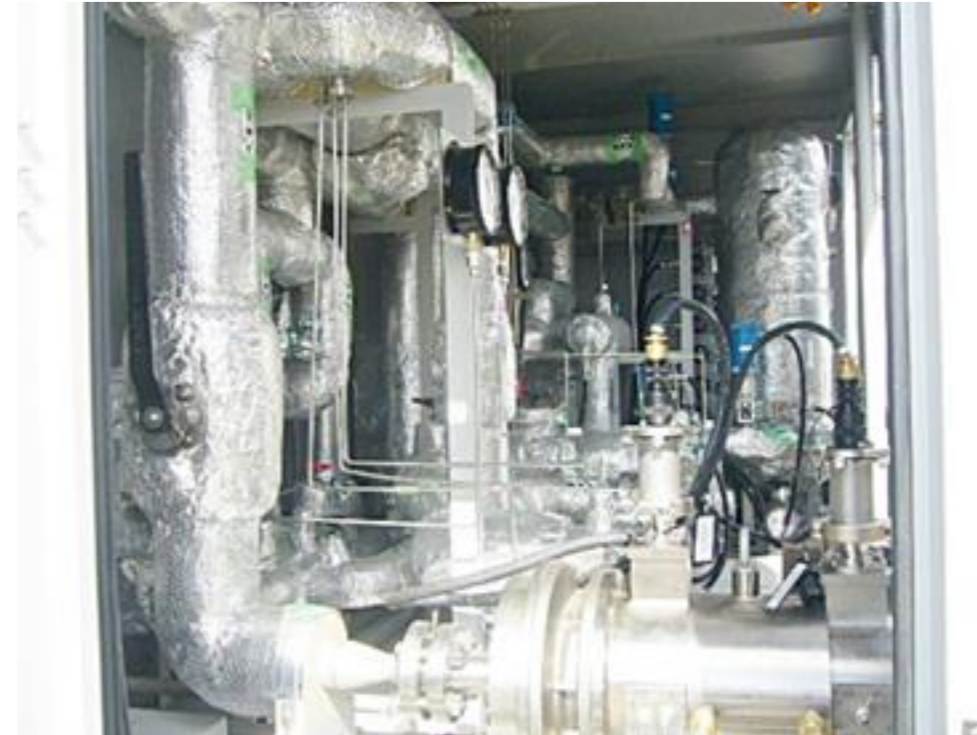
図. R600冷媒を使用した最高加熱温度200℃、加熱能力300kW級のヒートポンプ1次試作機の外観と内部
