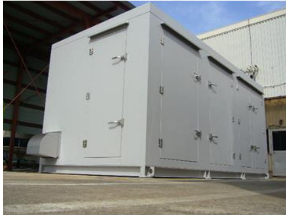
図. R600冷媒を使用した最高加熱温度200℃、加熱能力300kW級のヒートポンプ1次試作機の外観と内部
