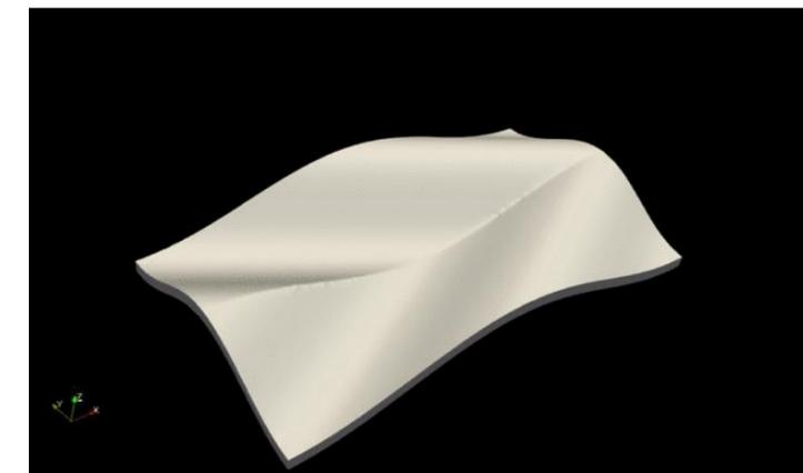
乱流V字凹凸伝熱面の最適化の例
