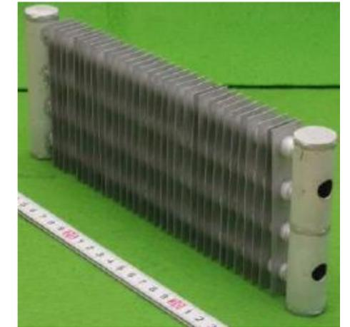
水道水中腐食量より推定した平均腐食深さ 給湯用オールアルミ潜熱回収熱交換器
