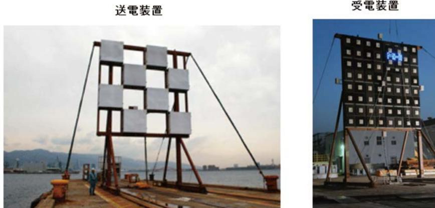
図20 宇宙太陽光発電の送電・受電用装置 (実験)
