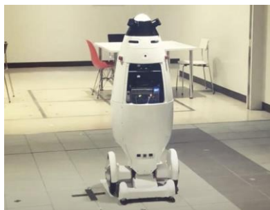
人込みでも自律して動く警備ロボット 出典：NEDOチャンネル
