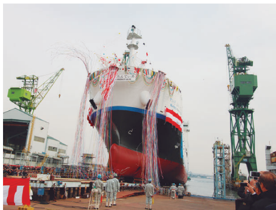
図3 ● 進水した液化水素運搬船
