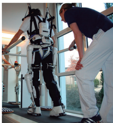
図5 ● CYBERDYNE が開発した装着型サイボーグ「HAL」
