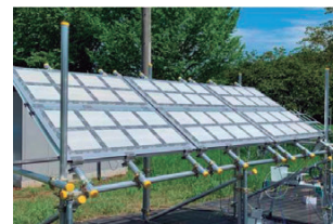
図16 ● 光触媒による水分解パネルのプロトタイプ
