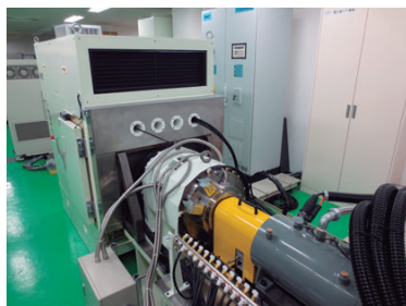
図12 ● 超高精度モーター損失分析評価装置
