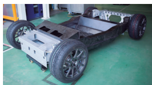
図1 ● 製作に成功したオール熱可塑性CFRPシャシー
