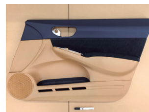
図4 ● リグノ CNF 強化樹脂で成形したドアトリム組み立て品
