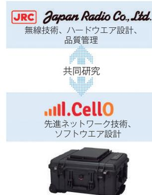
LTE コア網、基地局、アプリサーバーおよびバッテリー機能を可搬可能なワンボックスきょう体に集約し、目的の開発要件をすべて満たす可搬型LTEシステム装置開発を達成
