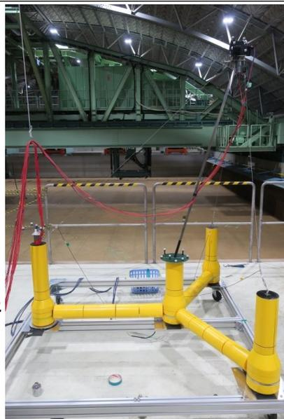
水槽試験用模型(1/60モデル)
