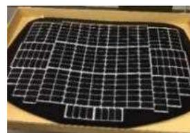
NEDO事業でシャープが開発した世界最高の変換効率31.17%のIII-V族化合物太陽電池モジュール製造技術を活用し、トヨタ自動車を実施する走行実証の仕様に基づき、新たにモジュール化した。自動車のフード(ボンネット)やルーフ、バックドア(リアハッチ)など、曲面部分に沿って搭載。「プリウスPHV」に搭載することにより、860Wの発電容量を実現、一日の充電で30km以上走行可能を実証できた。日産でも同様のモジュール(発電量1150kw)を組み込んだ実証車を作製し、実証走行を開始した。
