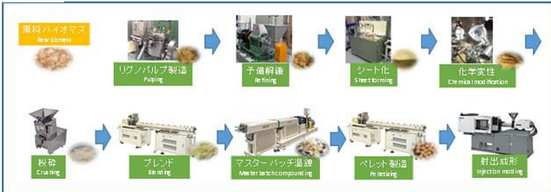
NEDO ニュースリリースより引用:「高性能ナノ繊維で強化した樹脂複合材料と高効率製造プロセスを開発」
