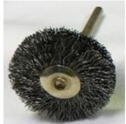
ワイヤーサンダー サイズ：Φ25×7 mm 毛材：スチール(0.15 mm)
