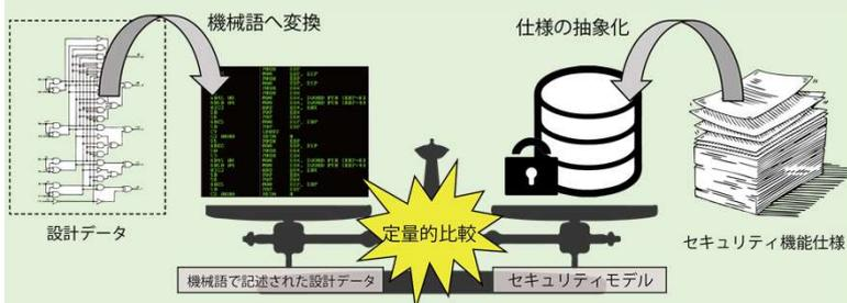
半導体チップ設計の際に第三者から購入する設計IPにHTが混入している場合を想定し、形式検証技術で設計IP内のHTを検知する方法を基礎理論として開発し、実証
