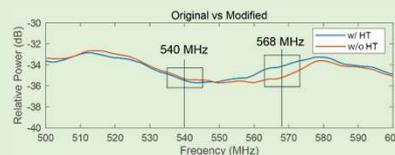
SCUに搭載したアクティブセンサを用いて周囲をセンシングしIC及び周囲の電気的な変化を計測することでHTの実装された位置を検出・動作を抑止
