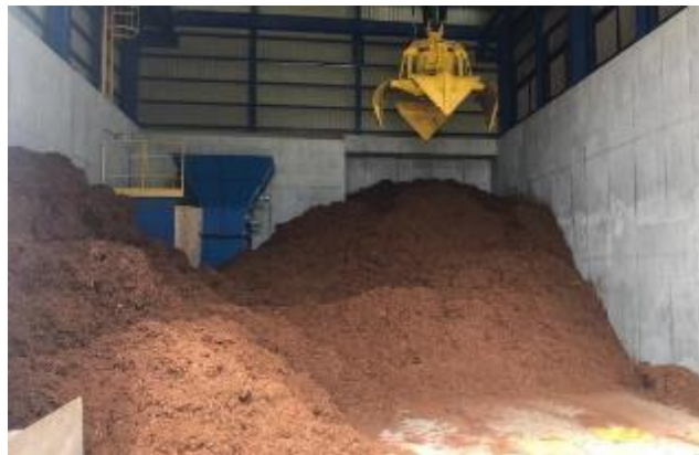
図 2.2.40 ポリップ型バケット付天井走行式フロアクレーン
