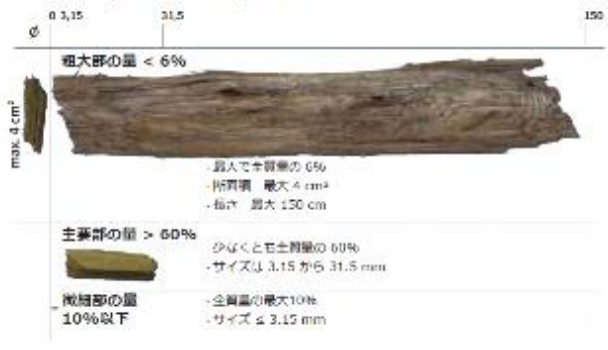
図 2.2.18 P16S 木質チップ規格 (左) P31S 木質チップ規格 (右)
