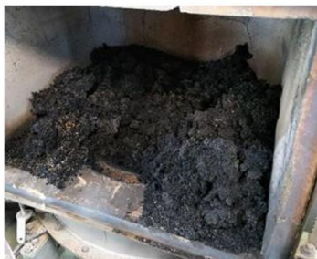
図 2.2.47 エリアンサス 100% 燃焼試験状況
