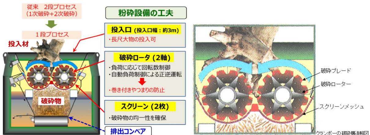
図 2.2.30 破碎設備 (CRAMBO) の特徴とスペック
