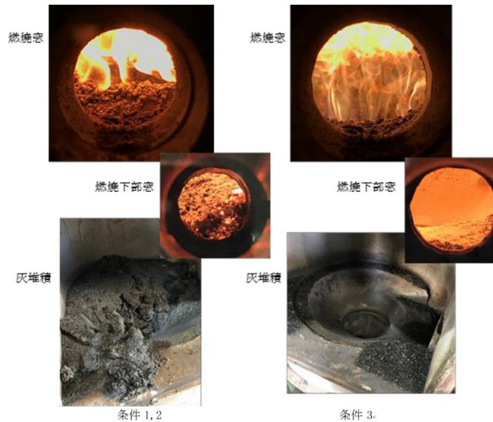
図 2.2.46 エリانس 50% 燃焼試験状況
