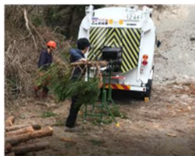
1人作業、人力にて投入
