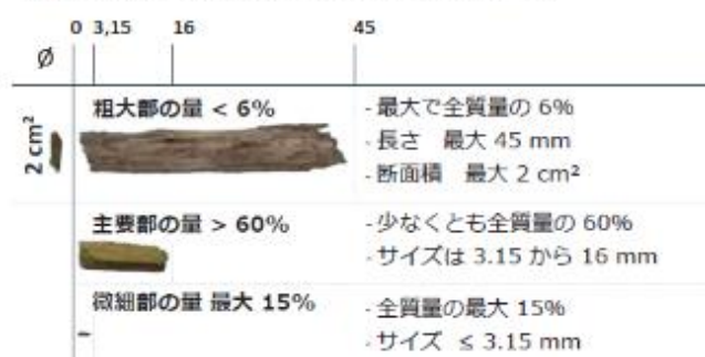
図 2.2.18 P16S 木質チップ規格 (左) P31S 木質チップ規格 (右)
