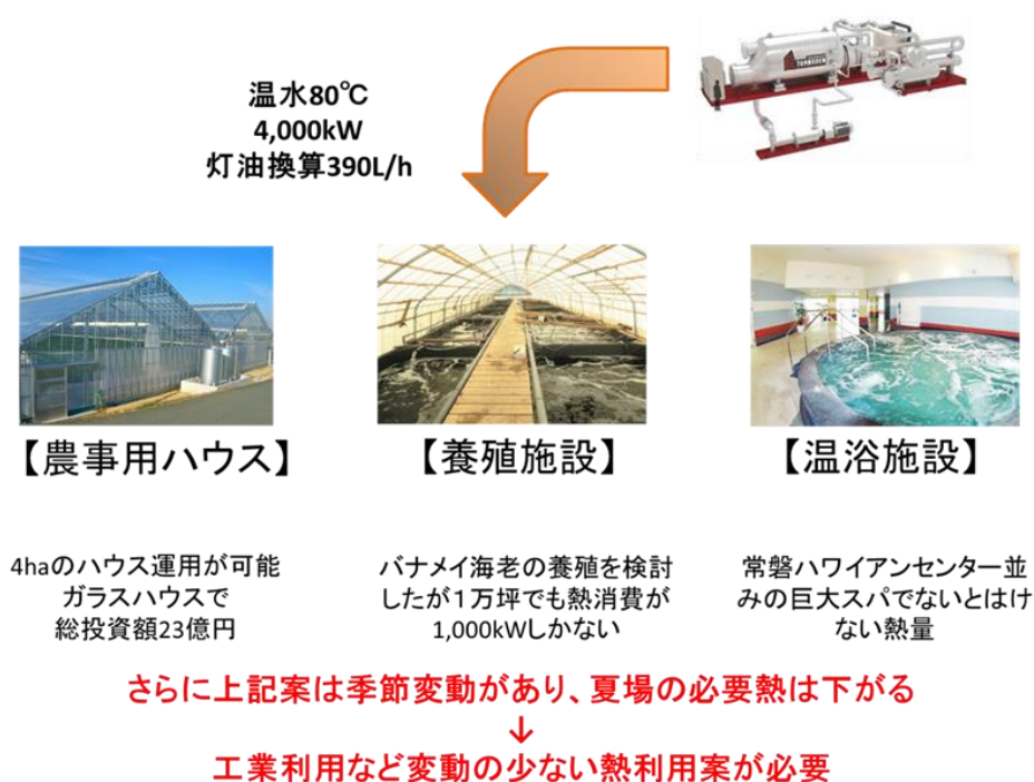
図 2.3.11 バンブー株式会社が導入した ORC における温水の供給先検討
