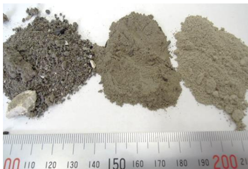
図 2.3.19 主灰 飛灰（サイクロン、バグフィルター）
