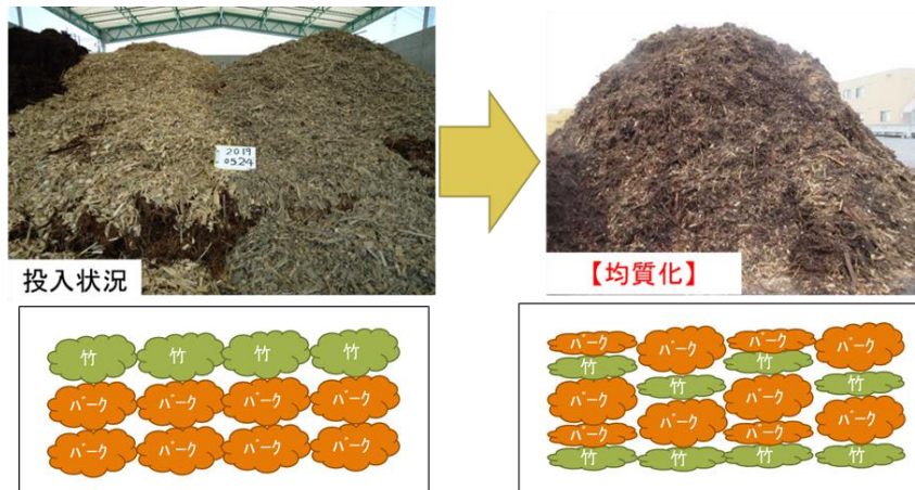
図 2.4.48 混合による燃料の均一化
