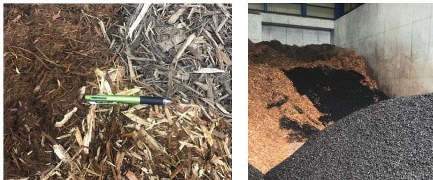
図 2.2.20 バークチップ（写真左：左上、中下）と枝葉チップ／PKS（写真左：手前） を受け入れた燃料槽内の様子（奥がバークチップ）（写真右）
