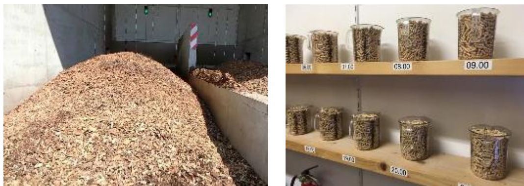
図 2.2.27 切削チップの例（左）と欧州木質ペレットの例（右）
