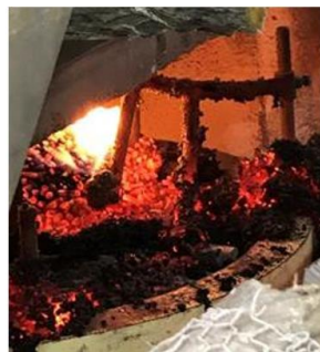
図 2.2.47 エリアンサス 100% 燃焼試験状況
