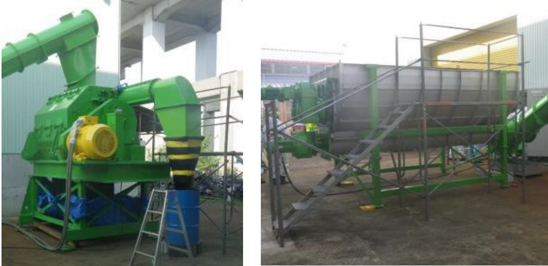
図 3.2.4 ハンマーブレード式破碎機の概観（左）セパレーションサイザー（破碎選別機）、（右）ドーザー （出所）株式会社いわむろバイオソリューション／株式会社大原鉄工所「平成 27 年度～平成 28 年度成果報告書 バイオマスエネルギーの地域自立システム化実証事業 エネルギー作物と家畜糞尿の混合メタン発酵とバイオマスエネルギーマネージメントが可能にする循環型農業システム化実証事業の事業性評価（FS）」（NEDO）2016 年
