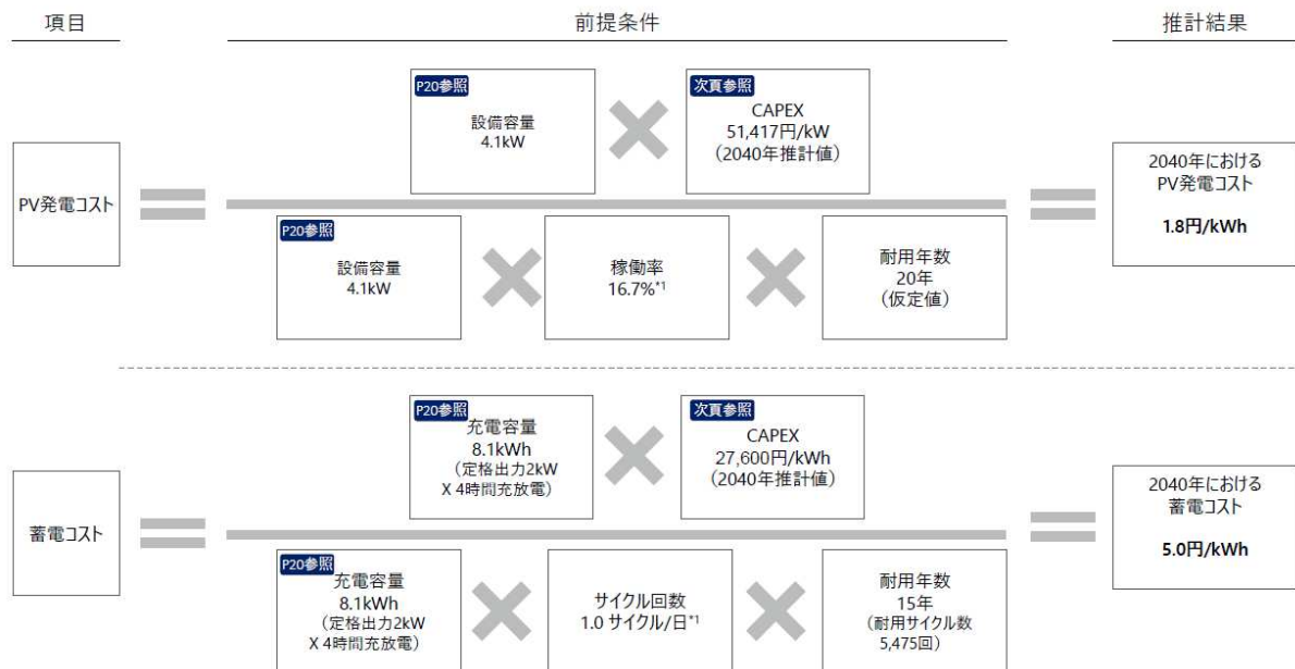
図 1.2.4(2)-20 PV 発電コスト、蓄電池コスト推計（2040年）
