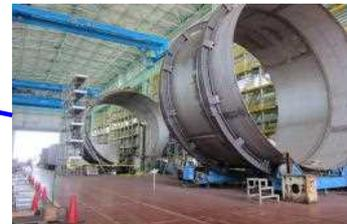
✓内槽鏡組立 (非破壊検査)
