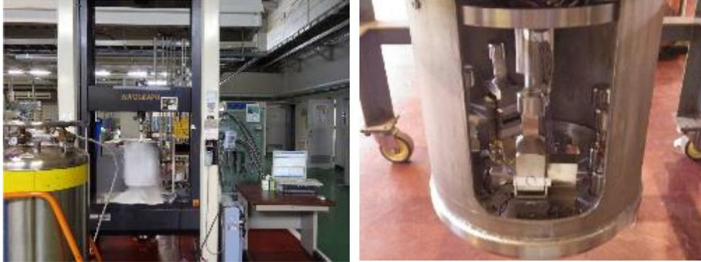
図一 1 0 J<sub>IC</sub> 試験実施装置 (写真)
