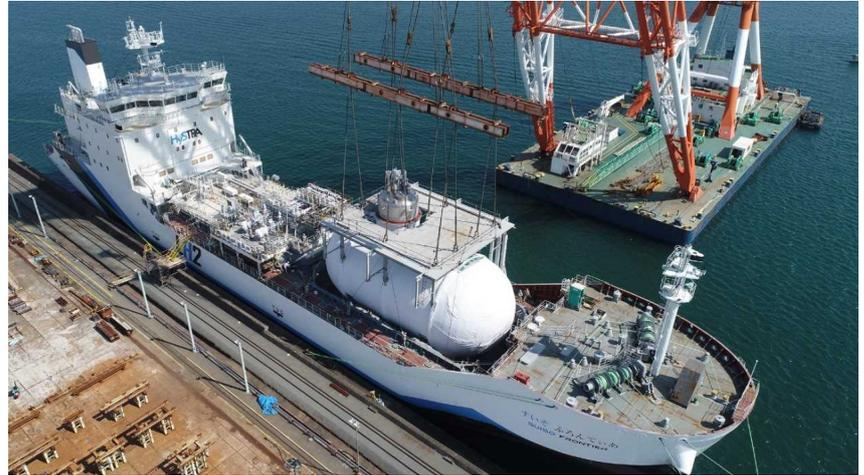
現在KHI神戸造船所内にて、貨物配管や各種貨物機器とのインテグレーション作業と試運転作業を実施中。
