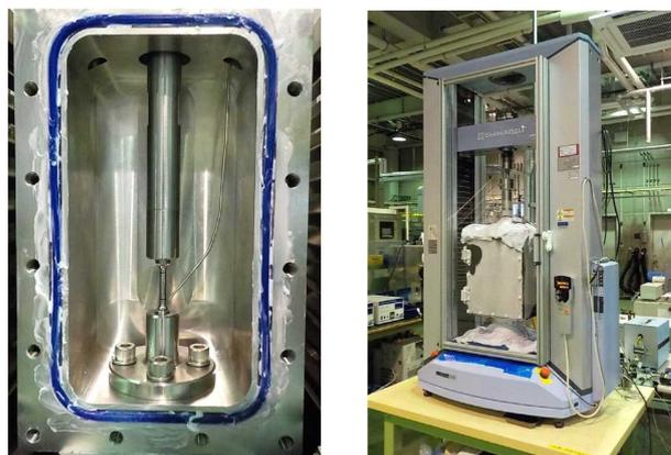
低歪速度引張試験（SSRT試験）装置
