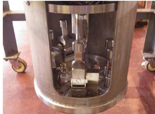
破壊靱性試験 ( $J_{IC}$ 試験) 装置
