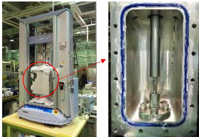
図一 1 2 SSRT 試験装置 (写真)
