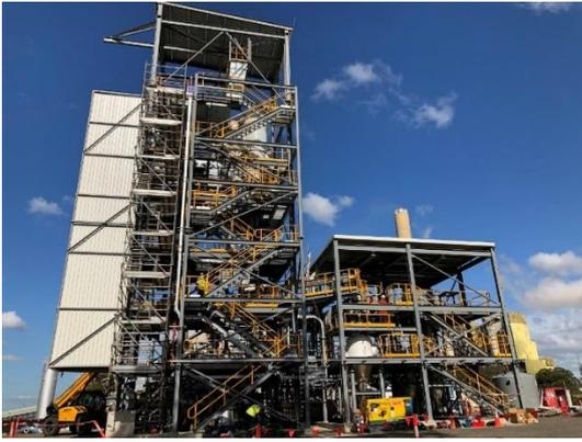
(a) ガス化炉、褐炭前処理装置
