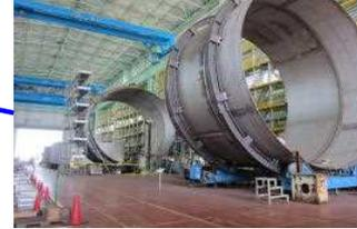
✓内槽鏡組立 (非破壊検査)
