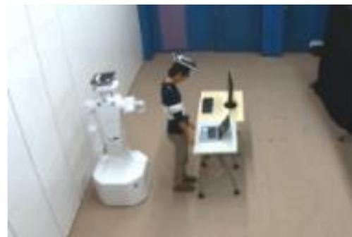
にパーソナルエリア(PA)を定義し、人に近づかない移動を行っている。そのため、人の密度が高く、移動できる空間が狭い場所では PA を確保した移動が困難である。そこで、接近した状態からでも移動を行えるよう、人とロボットの距離(干渉までの時間)を考慮した極近接の行動計画手法を開発した。
