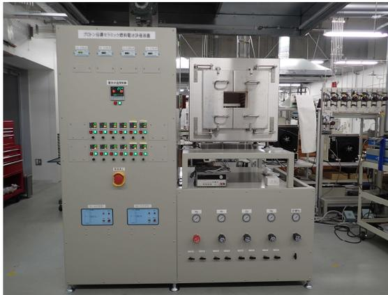
図1 製作したPCFC燃料電池評価装置； $\text{CO}_2$ 耐性評価装置については、2021年7月に導入予定
