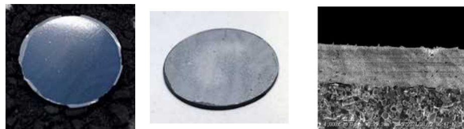
YSZグリーンシートを転写後 1250°C焼結後 1250°C焼結後SEM観察結果
