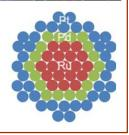
原子オーダーの独自の超精密構造制御技術を駆使し、カソード触媒におけるPtの触媒機能を飛躍的に向上させる。
