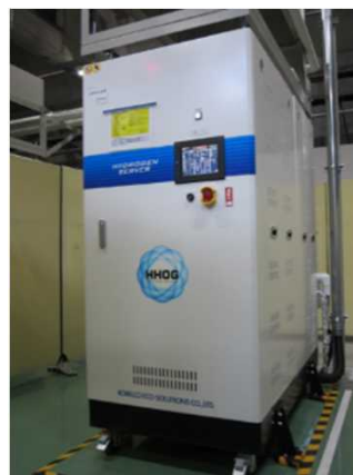
5Nm 3 /h 水素ポンプスタック評価対応装置
