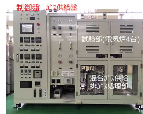
複合ガス環境試験装置の外観
